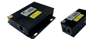
IP 2 WIRES CONVERTER Permet le raccordement d'un équipement IP distant sur 2 fils. Composé d'1 module "récepteur" installé en amont et connecté au switch et d'1 module "transmetteur" installé en aval et connecté à l'équipement IP distant. REF 310.5000-1
